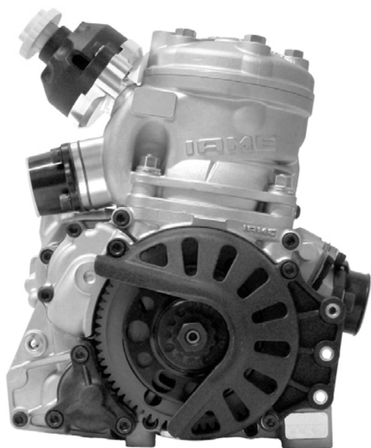
PHOTO DU MOTEUR CÔTÉ PIGNON PHOTO OF DRIVE SIDE OF ENGINE
